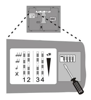
Sowohl der Ton als auch die Lautstärke kann mittels vier Schaltern auf der Rückseite des Displays reguliert werden.
