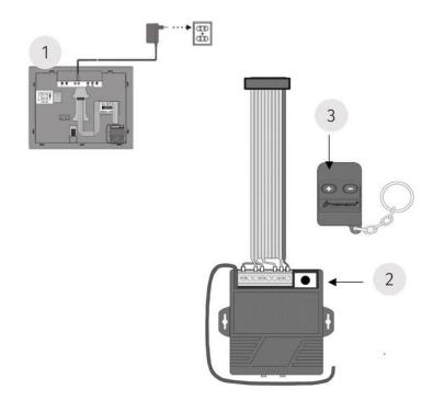
Schließen Sie das Display an die Stromversorgung (230 V) an.
