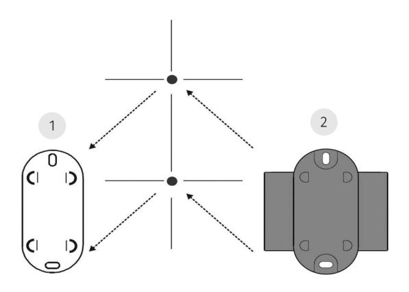
Falls ursprünglich ein Display ohne Receiver angebracht war, muss die ursprüngliche Halterung gegen die mitgelieferte Halterung getauscht werden. If a display was originally attached without a receiver, the original bracket must be replaced with the supplied bracket.
